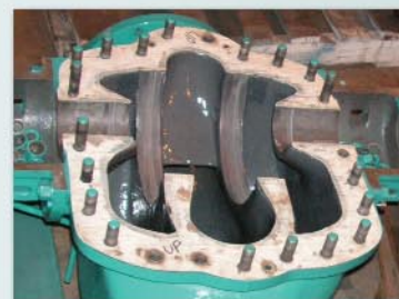
A teljesen megtisztított elhasználódott felület
